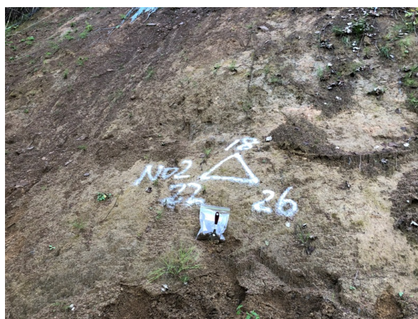
写真 2-4. 土壌硬度測定（No.2 崩壊地）
