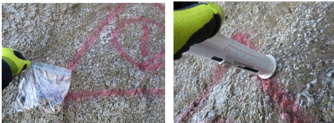
写真 2-2. 土壌硬度測定箇所（サンプル土壌は土壌検査用）
